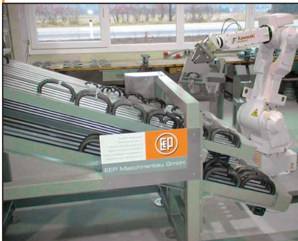
Zuführung der Teile vor Entnahme durch Roboter
