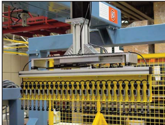
Spezialgreifer von EEP manipulieren Rohre mit vielseitigsten Abmessungen
