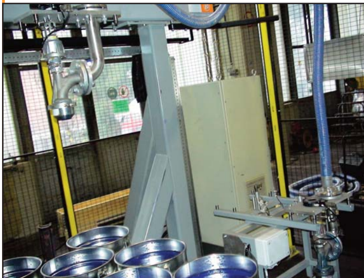
Exakte Dosierung der Farbmengen und flexibler Einsatz beim Kunden
