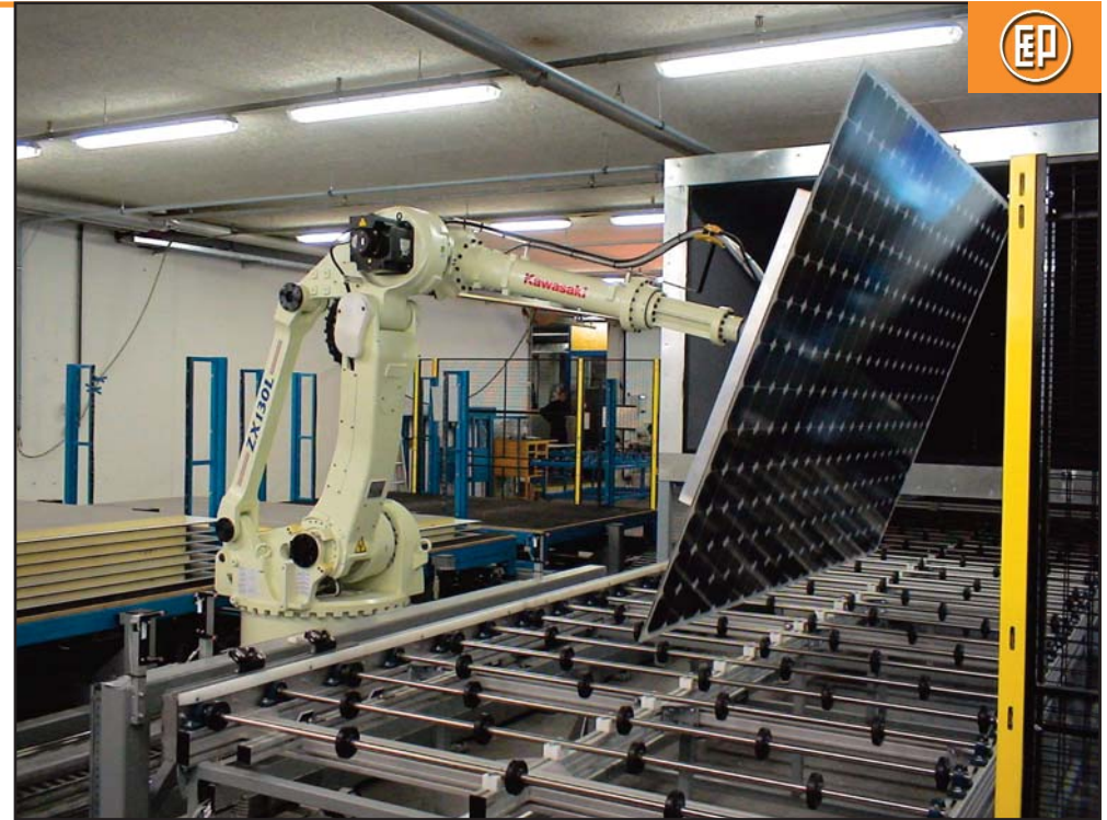
Messeinrichtung für Solarmodule
